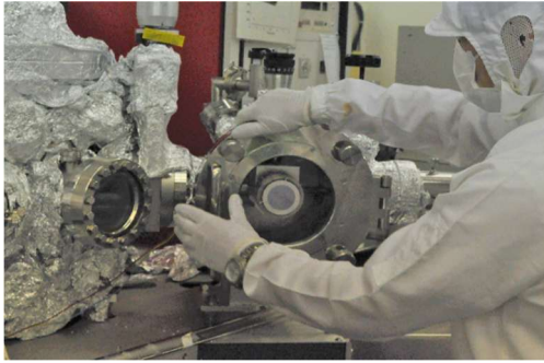
スパッタリング装置ウェハセッティング風景
