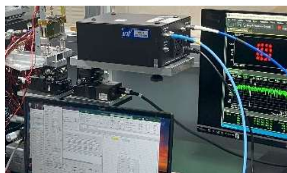
300GHz 帯 CMOS フェーズドアレイトランシーバによる高速無線伝送実験
