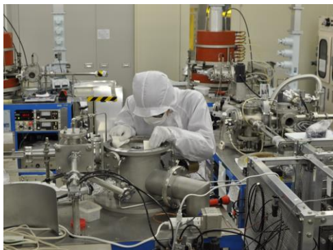
エッチング装置メンテナンス作業風景 During maintenance of dry etcher
