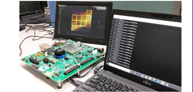
リアルタイム内視鏡画像診断支援システムのエッジデバイス実装 Overview of Implementation of a real-time endoscopic image diagnosis support system on edge devices. URL https://bit.ly/2MnelZ2
