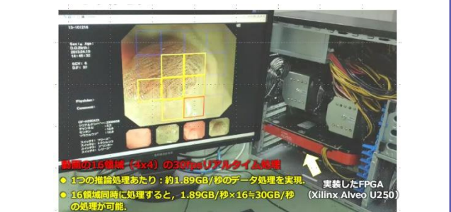
カスタマイズ DSP コアへのプロトタイプシステムの実装 Implementation of a prototype system on a customizable DSP. https://ieeexplore.ieee.org/document/8702379
