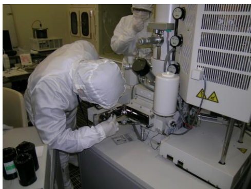
SEMロードロック室へのウェハセッティング風景 Wafer setting to SEM load-lock chamber
