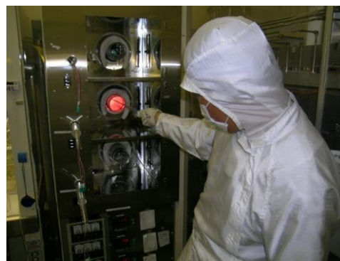
酸化・拡散炉キャリア搬送風景 Wafer loading into furnace
