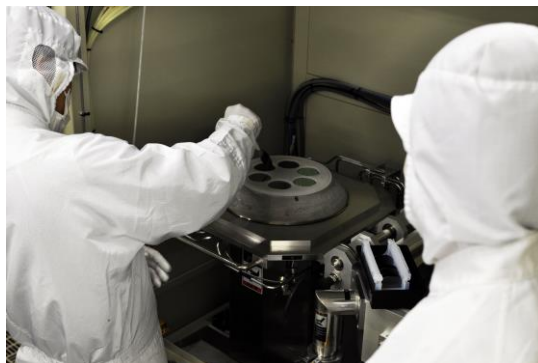
常圧CVDウェハセッティング風景 Wafer setting to atmospheric CVD reactor
