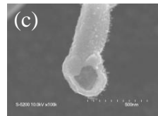
(a)気相浮遊コーティング法による多層カーボンナノチューブ(MWCNT)複合体の作製概念;(b)作製された酸化チタン被覆MWCNT;(c)酸化チタン被覆とMWCNTの焼成除去で得られた中空酸化チタンナノチューブ
