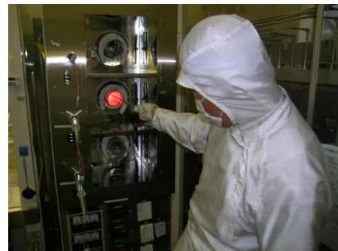
酸化・拡散炉キャリア搬送風景 Wafer loading into furnace
